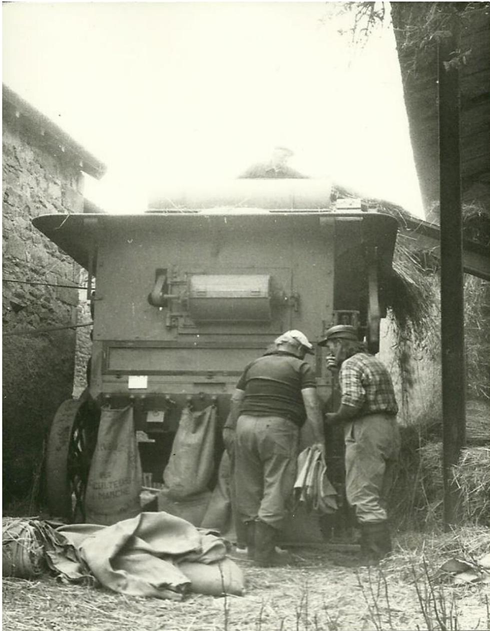
Les porteurs de sacs s'affairent derrière la batteuse pour accrocher les sacs aux ouies de remplissage, et ils surveillent le débit du grain afin d'en interrompre le débit en obturant l'ouverture par une lame de fer coulissant dans des gorges latérales lorsque le sac est plein.
